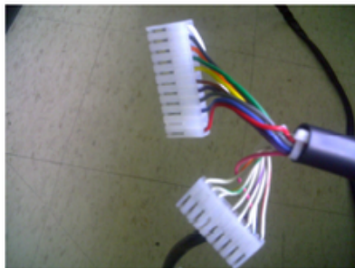
Conectores de motores en la tarjeta de control
